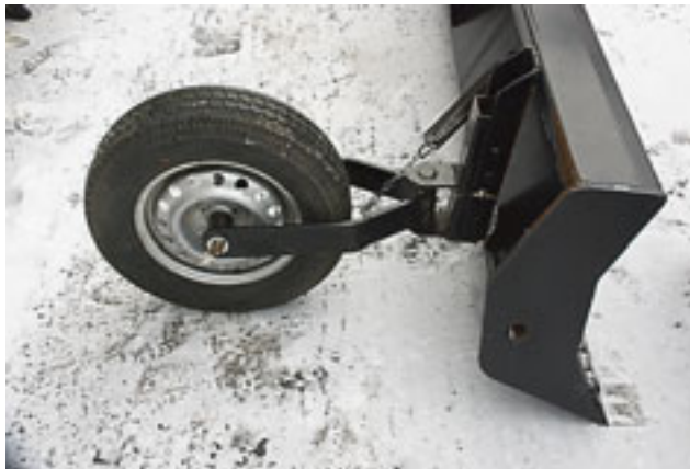
Tukipyörä työasennossa. Kun lana nostetaan ylös, pyörä nojaa automaattisesti lanan takaseinään.
