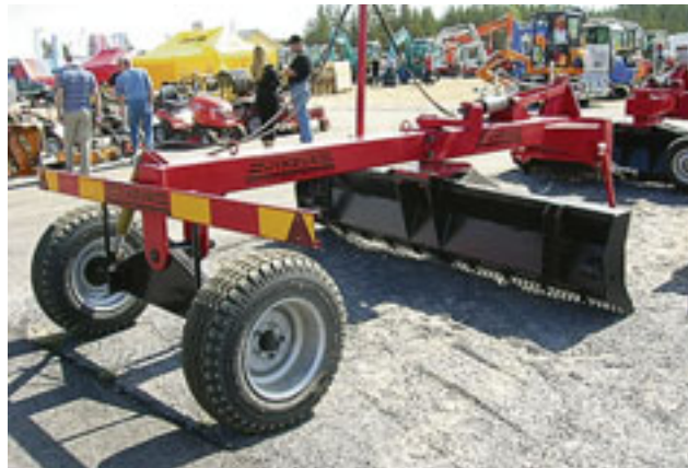
Jos Jykevä varustetaan jatkopuomilla ja vetolaitteella, "takalanasta" tulee hinattava. Tällöin on mahdollista myös kallistaa terää sylinterillä, joka on kiinni taka-akselissa.
