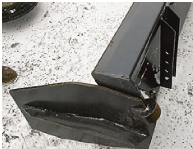
Päätylevy keräävässä asennossa. Levy lukittuu hakasen taakse, ja levy väistää estettä tarvittaessa, kun se pääsee kiertymään akselinsa ympäri ylös taakse.
