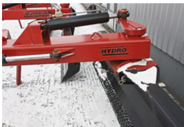
H 30:n kääntöniel on 125-millinen tappi, joka voidellaan takaa. Kääntönielissä on lukkoventtiili vakiona, jolloin teränkulma pysyy haluttuna.
