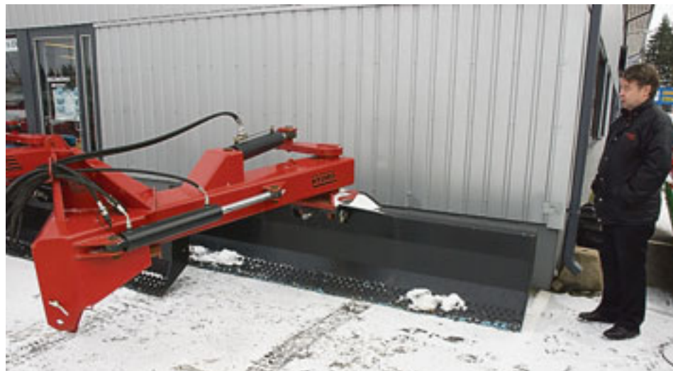
Jykevän jykevin malli on H 30, jossa on myös hydraulisesti kääntyvä runko. Takalanaa esittelee Pasi Vesamo.
