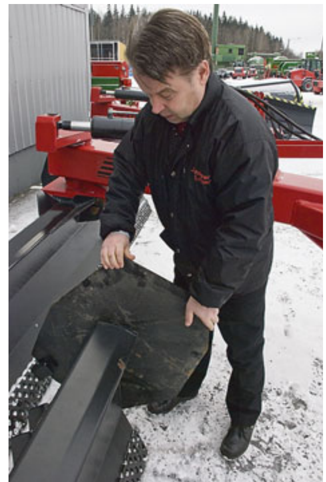
Pasilla päätylevyn kääntö meneillään. Levy on yläasen- nossa, josta se lasketaan työasentoon oikealle alas.
