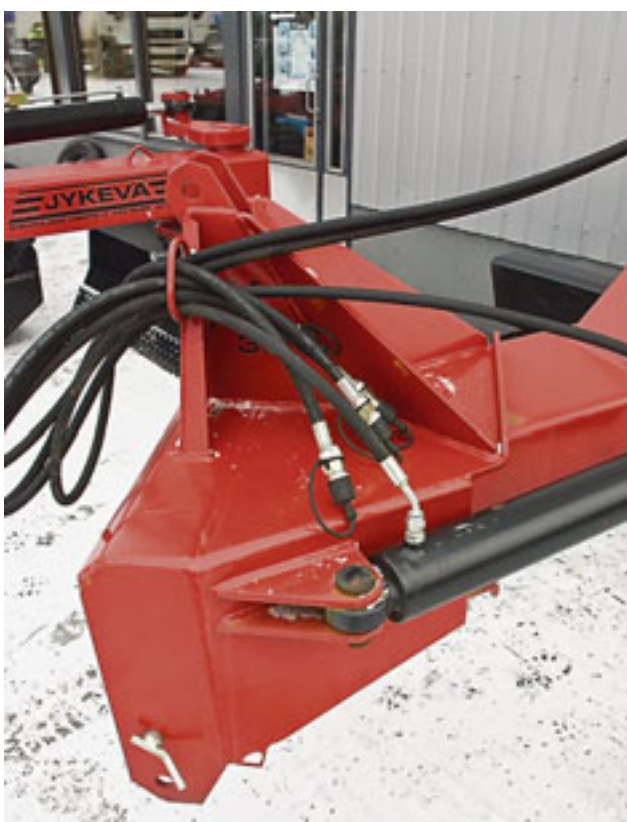
H 30 on suunniteltu käytettäväksi 100–200 hevosvoimaisella traktorilla, joten rakenteet ovat sen mukaiset. Kääntö- sylinteri on tiukasti kiinni rungossa.
